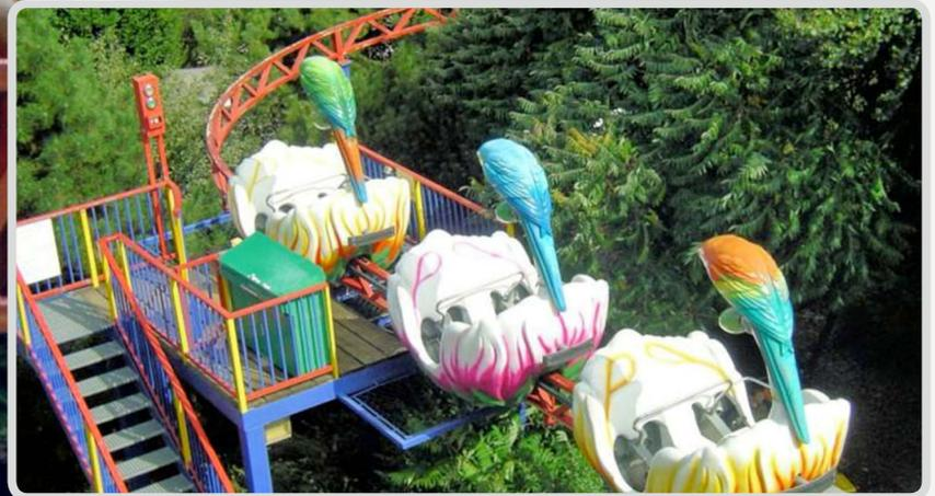
**Betrieb bei An- und Abfahrt** | Für die Abfahrt und Ankunft muss jeweils eine Plattform von der Größe eines Fahrzeugs erstellt werden. Zwischen den Stationen reihen sich die Fahrzeuge mit Hilfe eines Elektromotors automatisch auf und können aufgrund der Höhe auch nicht von den Gästen erreicht werden. Das Startprocedere wird durch einen Bediener geleitet.
